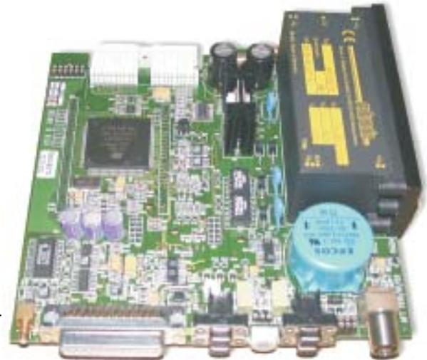
eine der ersten mit dem bleifreien HAL-Lot von Balver Zinn gefertigten Baugruppen, Fa. AFT Atlas Fahrzeugtechnik, Weidohl
